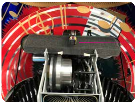
FIG. 2 : Mécanisme en mode transit avec la mousse de maintien
